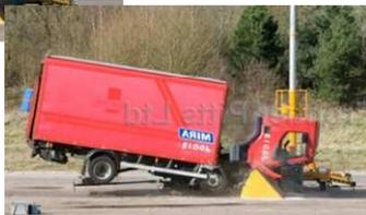
La version ATTB 80 stoppe un véhicule de 7,5tonnes lancé à 80 km/h.
