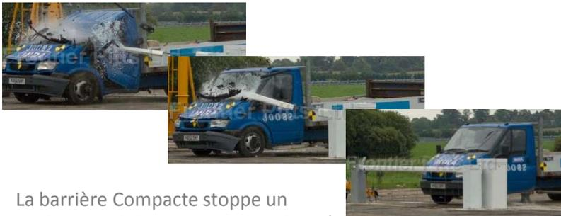
La barrière Compacte stoppe un véhicule de 3,5 tonnes lancé à 48 km/h.
