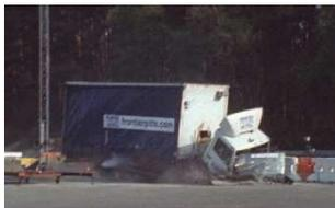
Les bornes escamotables ATRB 80 stoppe un véhicule de 7,5 tonnes lancé à 80 km/h.
