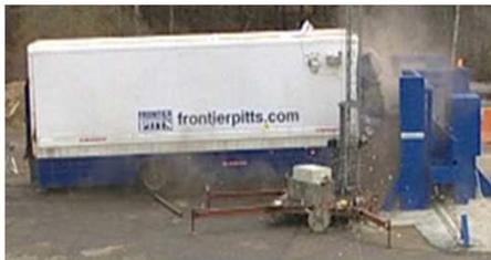
La poutre coulissante ATBB 80 stoppe un véhicule de 7,5tonnes lancé à 80 km/h.
