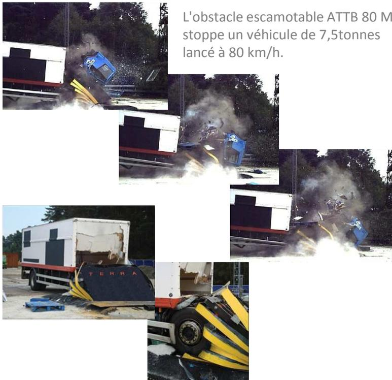
L'obstacle escamotable ATTB 80 M stoppe un véhicule de 7,5 tonnes lancé à 80 km/h.
