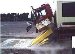
La barrière ATTB 80 stoppe un véhicule de 7,5 tonnes lancé à 80 km/h.
